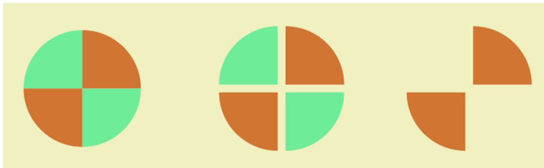
Slika 1: Grafični prikaz metode mešanja in deljenja vzorca s četrтinjenjem
