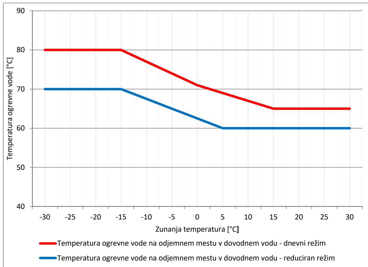
Opomba: Dovoljena odstopanja temperature ogrevne vode v dovodnem vodu na odjemnem mestu  $\pm 3$  °C
