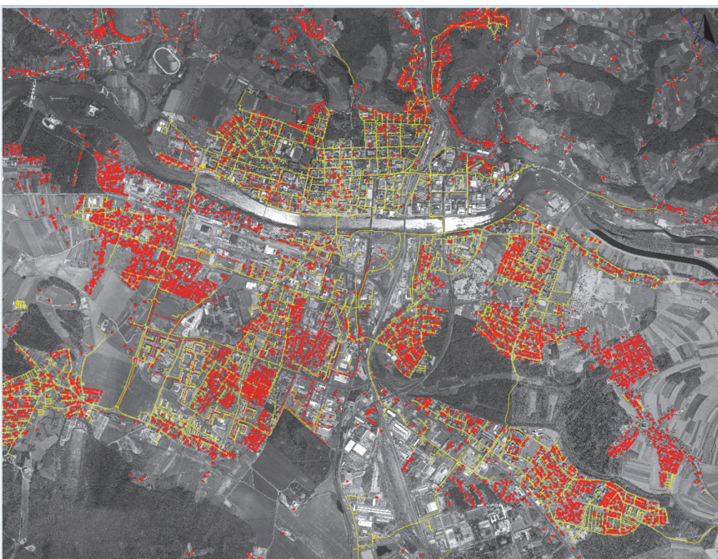
Slika 4.2: Prostorska razporeditev kurilnih naprav na tekoče gorivo skupaj s plinovodnim (rumene linije) in vročevodnim (rdeče linije) omrežjem v občini
