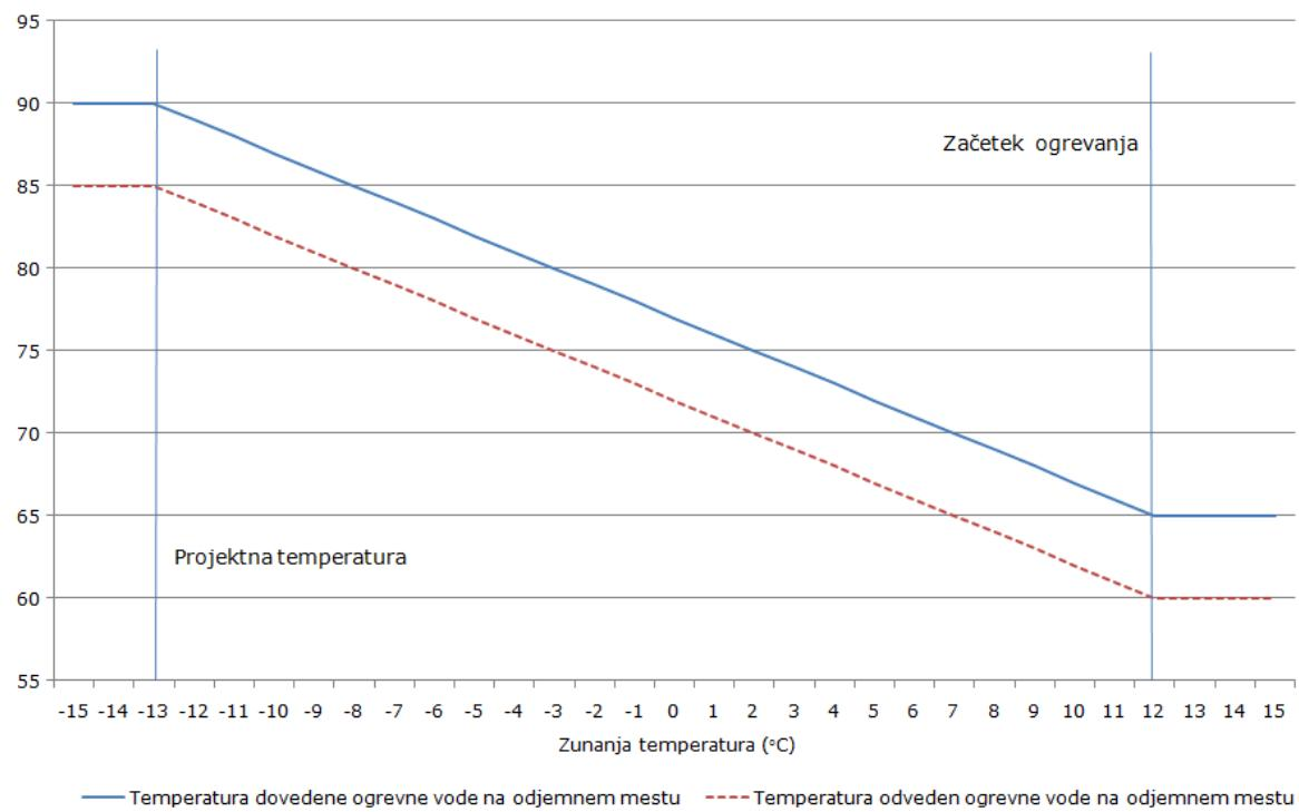
Dovoljeno odstopanje temperature ogrevne vode na posameznem odjemnem mestu v dovodnem vodu je  $\pm 3^{\circ}\text{C}$ .
