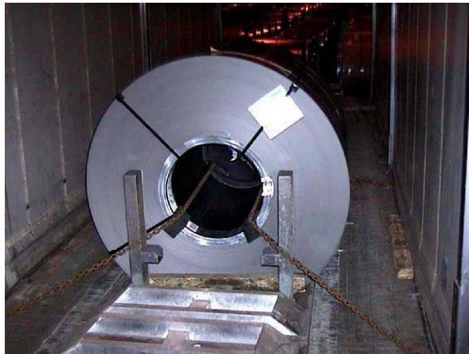
Za preprečitev premikanja naprej uporabimo (prečni) opornik. Ta ne sme povzročati udrtin na tuljavi. Zato (prečni) opornik in kontaktne površine zaščitimo (npr. s sintetičnimi tkaninami).
