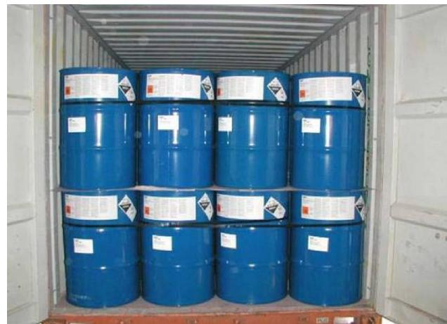
*Jekleni sodi, dvojno naloženi v blokadno skladovnico in varovani z napenjalnimi trakovi, pritrjenimi na ohišje zabojnika:*
