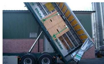
Učinkovitost ureditve varovanja izmenjevalnika preskušamo s pospeševanjem naprej in nazaj.
