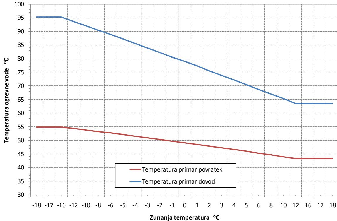
Opomba: Dovoljeno odstopanje temperature ogrevne vode na posameznem odjemnem mestu je  $\pm 3^\circ\text{C}$
