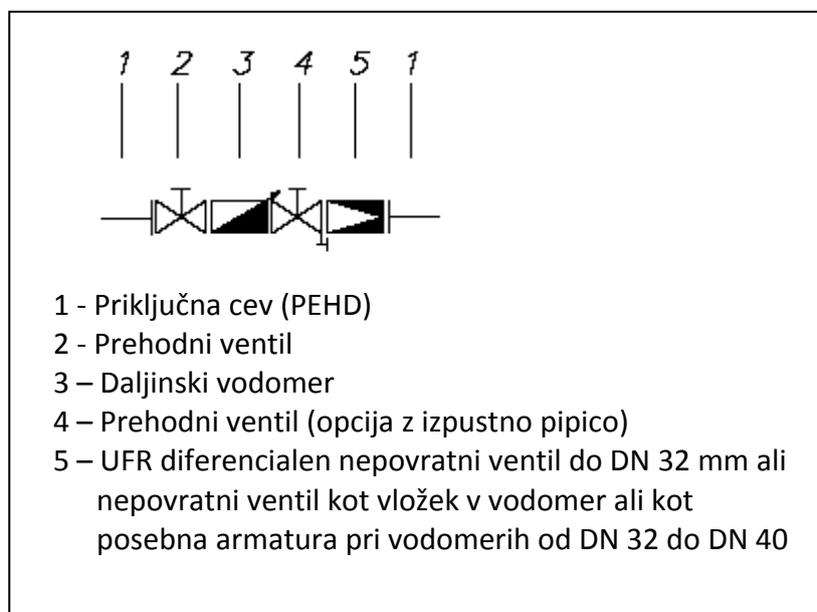
**PRILOGA št. 4: Slika 2: Merilno mesto priključka do DN 40 z reducirnim ventilom tlaka (sestav in zaporedje obveznih elementov)**
