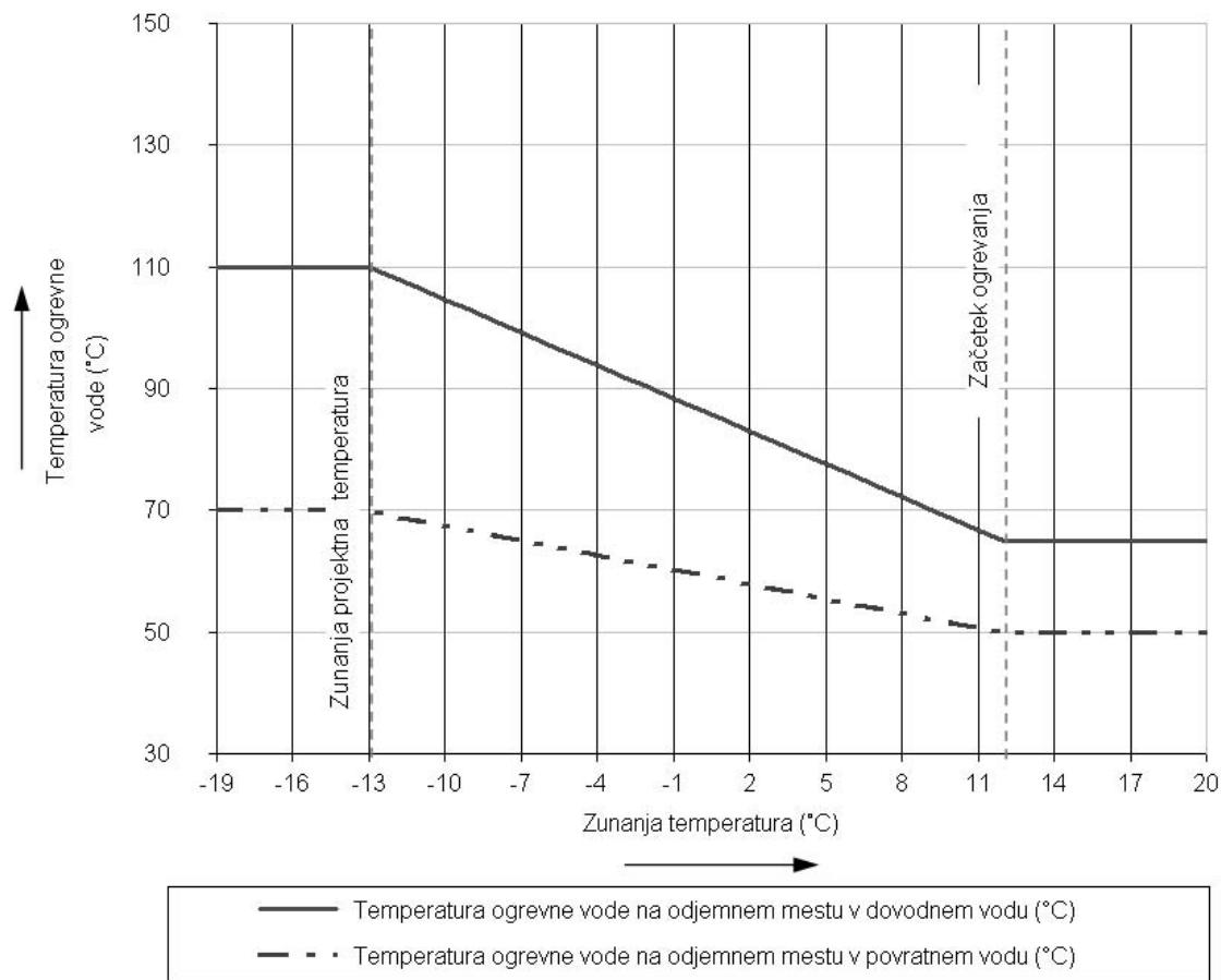
Opomba: Dovoljeno odstopanje temperature ogrevne vode na posameznem odjemnem mestu je  $\pm 3^{\circ}\text{C}$
