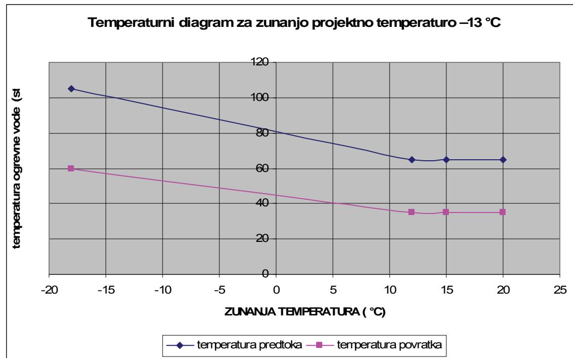
Opomba: Dovoljeno odstopanje temperature ogrevne vode v dovodnem vodu - predtok je  $\pm 5^{\circ}\text{C}$ .
