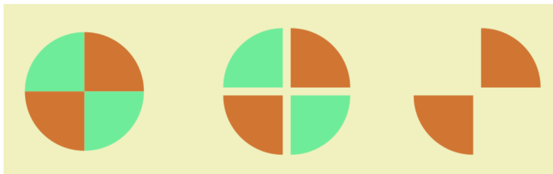
Slika 1.: Grafični prikaz metode mešanja in deljenja vzorca s četrtinjenjem oziroma metode delitve vzorca na četrtine
