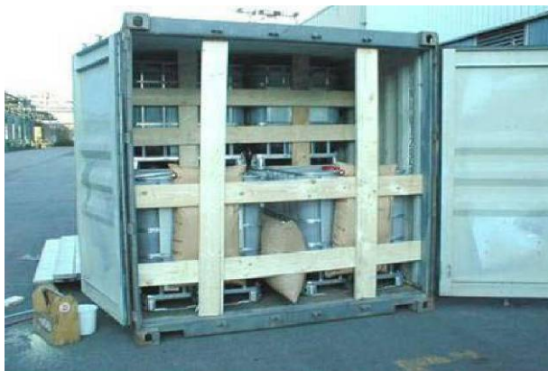
Slika 60: Zabojniki za shranjevanje polizdelkov (IBC), naloženih dvojno
