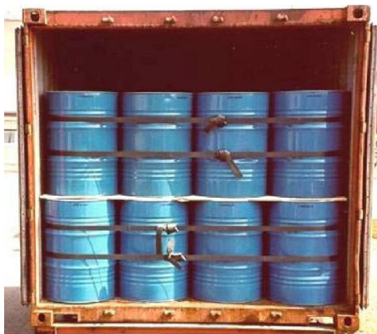
Slika 59: Posamezni sodi, naloženi v zabojniku, dve plasti v štirih vrstah
