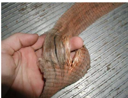
Slika 20: Močno poškodovana oprtnica (Vrzite jo v smetnjak!)
