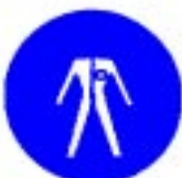
Obvezna uporaba zaščitnega kombinezona
