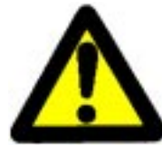
Pozor! Splošna nevarnost
